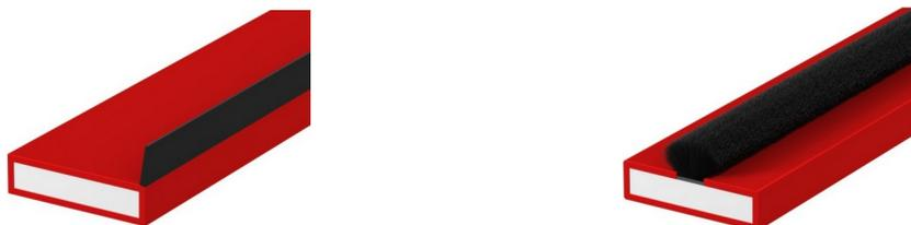
Colocado adecuadamente en el canto del elemento cortafuego/acústico la junta LP actúa como junta acústica en situación normal. En caso de incendio bajo acción del calor del fuego el silicato sódico se hincha con presión realizando la estanquidad perfecta de las franquicias. De esta forma, además de su capacidad de enfriamiento, se impide el paso de humos calientes, gases y llamas.
